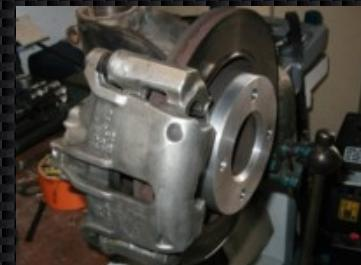
J'ai acheté des cales en alu afin de récupérer la largeur de voie perdue par la fusée de 205 mazout!.
