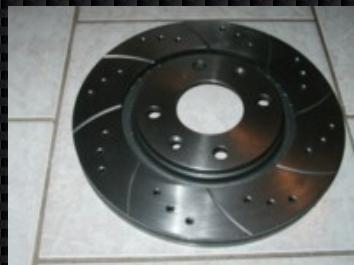
Voici les disques montés sur la voiture. Ce sont des ventilés/rainurés/percés, en provenance directe d'angleterre.
