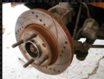
Voici l'étrier de marque Bosch qui sera monté sur le porte moyeu de la 205 GTI 1,6L. Il existe deux variantes: disques en 266mm\*20.4 d'épaisseur et 226mm de diamètre pour 22mm d'épaisseur. Celui ci est du type 266mm \* 20.4
