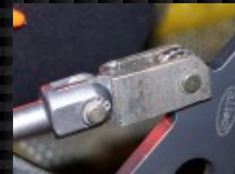
Fabrication d'une nouvelle chappe afin de rallonger la tige du maître cylindre
